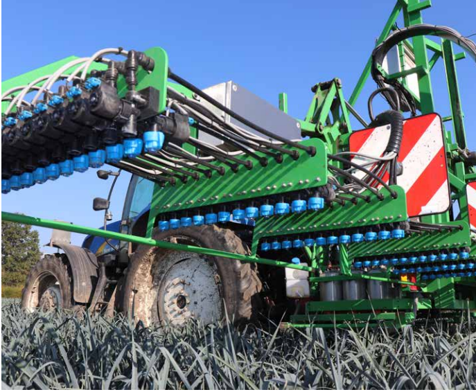
De praktijkcentra beschikken over aangepaste spuitapparatuur om gewasbeschermingsmiddelen te testen. Links: proefveldspuit PSKW; rechts: proefveldspuit PCG
